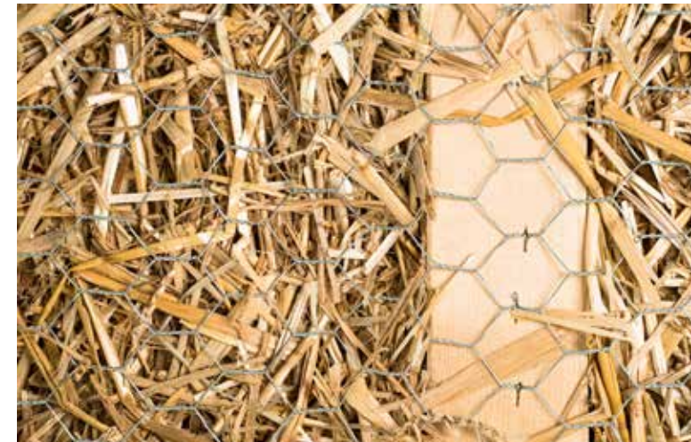
Die Elemente mit der Strohdämmung müssen am Bau schnell und trocken geschlossen werden.
